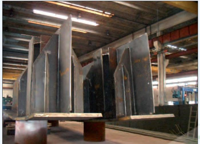
Figura 4 - La fase di assemblaggio degli elementi di concio
