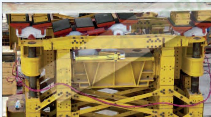
Figura 9 - La struttura dell'articolato per il varo a spinta del viadotto
